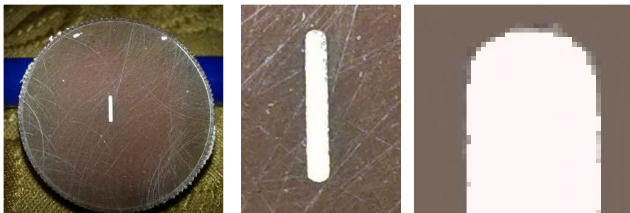
Рис. 5. Поперечный спил зуба берда № 65 (зона II)
