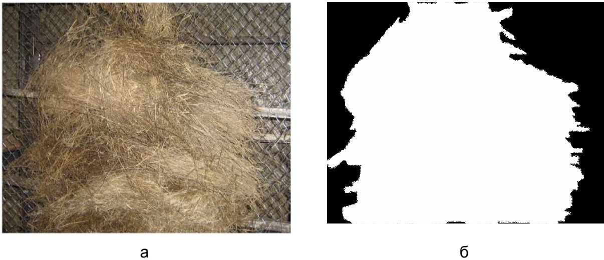
Рис. 3. Исходное (а) и обработанное (б) изображения участка слоя на транспортере
